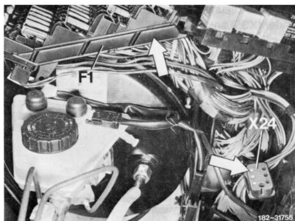
F1 Sicherungskasten X24 Steckverbindung Scheinwerferleitungssatz
