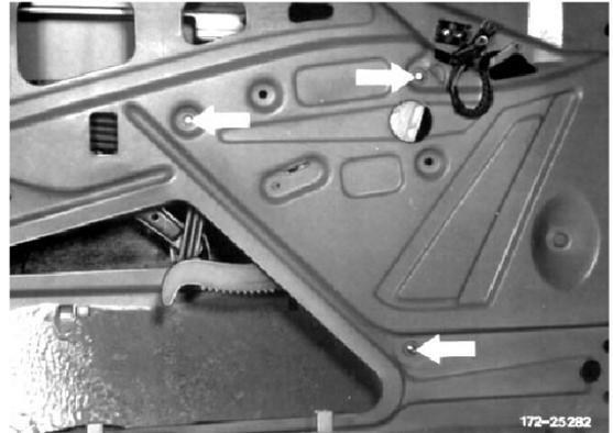
12 Fensterhebearm vorn in die Fensterhebeschiene einsetzen und mit Mutter befestigen.
