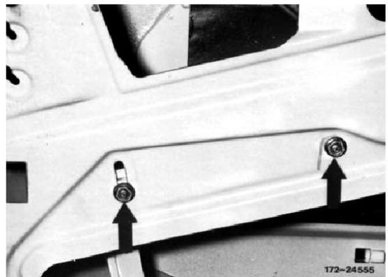
9 Fensterheber mit Motor aus der Fensterhebeschiene herausziehen und nach unten herausnehmen.
