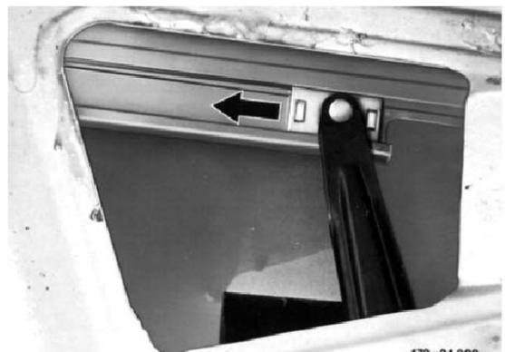
11 Fensterheber mit den Gewindebolzen am Türinnenblech einfahren und befestigen.
