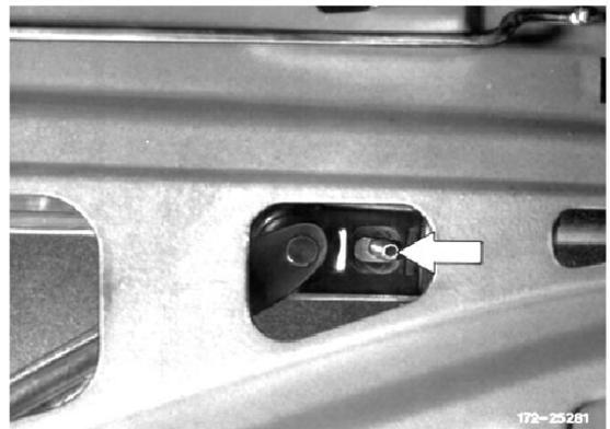
13 Führungsschiene von vorn in das Führungsstück einführen und am Türinnenblech befestigen.
