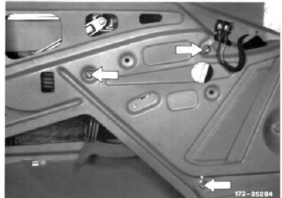
8 Muttern an der Führungsschiene herausdrehen und Führungsschiene nach vorn aus dem Führungsstück herausnehmen.
